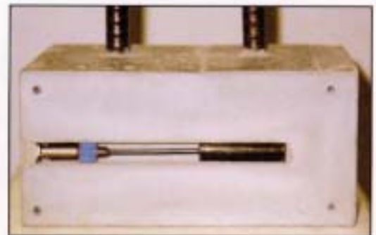
チタンロッド陽極棒挿入状況
