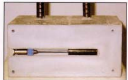
チタンロッド陽極棒挿入状況
